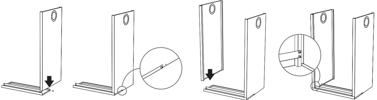
**2** Colocar el perno inferior, a continuación la puerta. Poner el perno superior que va en la puerta y montar el techo. Atornillar el techo completamente.
