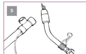
Para la instalación de accesorios roscados, recomendamos colocar una junta plana. Está prohibida la utilización de estopa / esparto).
