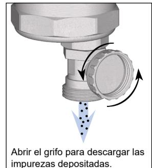
Abrir el grifo para descargar las impurezas depositadas.
