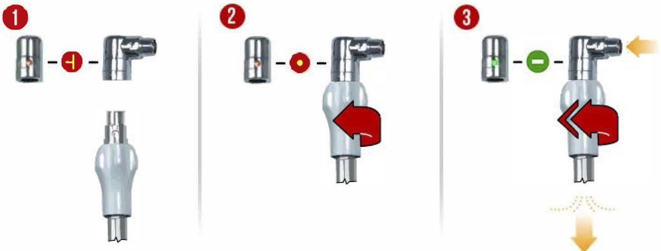
Inserte el enchufe rápido en la válvula de seguridad. El visor está en rojo, por lo que el paso del gas está cerrado.
