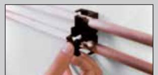
La abrazadera para las canales 32 x 35 y 40 x 70 puede soportar tuberías de diámetros 10 hasta 22 mm.
