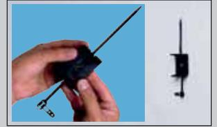
Ajuste de la abrazadera según la dimensión de la canal.
