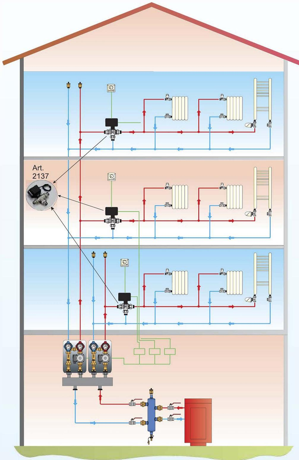
En el esquema se representa una instalación de calefacción por zonas gestionado por válvulas de zona de 3 vías con by-pass y 4 racores de conexión (art. 2137), instalada en la central térmica. Los termostatos controlan el cierre y apertura de la válvula y los contadores contabilizan los tiempos de uso de la caldera para cada una de las zonas independientes. Cuando la válvula se cierra la bomba de la caldera se para interrumpiendo el envío de calor.
